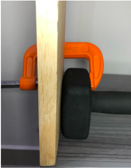
Figura 4A: uso de clamps para fijar la estructura
